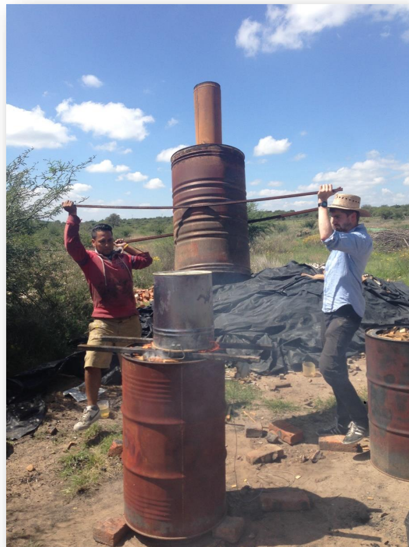
Miembros del equipo de Caminos Billy y Nico fabrican bio carbón de hueso en un gasificador de baja tecnología
