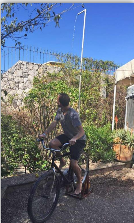
Primer prototipo de la bici-bomba bombeando a 3 metros de altura
